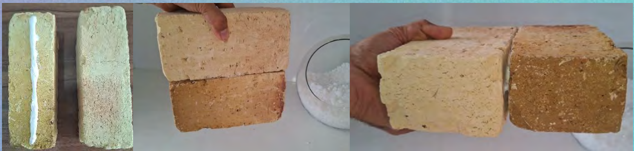
معلق ماندن آجر سنگین در نیروی کششی و برشی با استفاده از چسباندن یک لایه نازک نانوعایق هواژل و عایق کاری کامل درز بین آجرها
