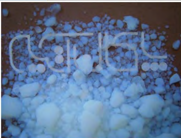
عایق گرانول ایروجل نانومتخلخل فوق آب گریز
